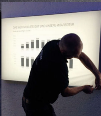
Die im Digitaldruckverfahren bedruckten Displaystoffe werden mittels Flachkeder in den Aluminiumrahmen gedrückt.
